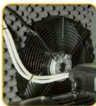
Ventilación forzada para una mejor refrigeración. Para las versiones a estrella-triángulo, el ventilador funciona bajo termostato
